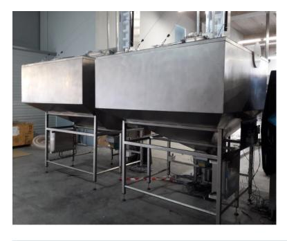
Nos trémies de stockage inox existent en différentes dimensions et volumes. Elles peuvent être équipées de couvercles manuels ou actionnés par vérin.
